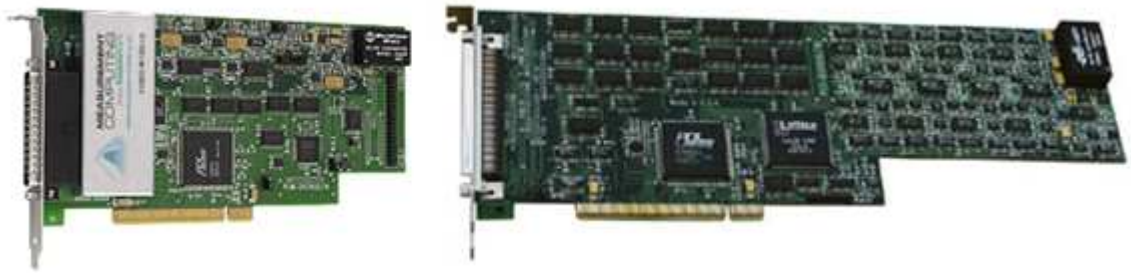
Figura 2.7: Schede di acquisizione dati dell'esoscheletro Pneu-WREX. Pneu-WREX utilizza tre schede PCIM-DAS16JR/16 PCI (sinistra) e una scheda PCIM-DAS16JR/16 PCI (destra) [38]
