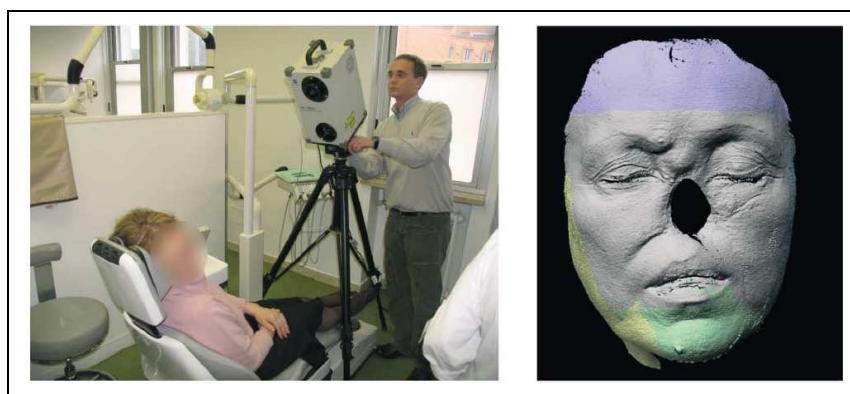
Illustrazione 12: Scannerizzazione del volto [3] di una paziente priva di naso e risultato del modello ottenuto dalla nuvola di punti dati dalla scannerizzazione tramite un operazione di mesh (sostituzione dell'informazione di posizione di ciascun punto, con l'informazione di contiguit  fra punti adiacenti).
