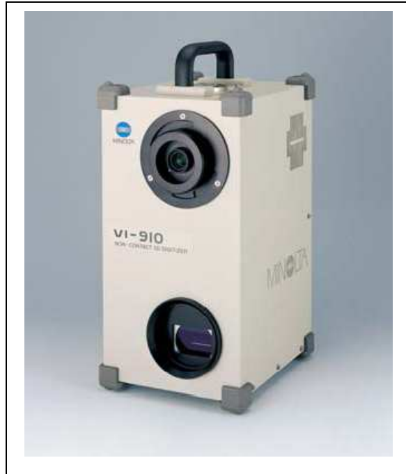
Illustrazione 11: Strumento (MINOLTA VI-910 [4] ) per la scannerizzazione di superfici corporee al fine di produrre protesi “ah hoc”, soles ortopediche ed altro. Dotato di tre lenti intercambiabili in funzione della distanza dal soggetto ( f=8,14,25 mm) per un range di distanze da 0.6 a 2.5 m. L'area scansionabile (dipendente dalla distanza) e' al minimo 111mm x 83 mm, al massimo 1196 mm x 897 mm, precisione in profondit  di \pm 0.008 mm, tempo di scannerizzazione da 0.3 secondi (per modalit  FAST) a 2.5 secondi (per modalit  FINE), disponibile con laser di classe 1,2 o “Eye-safe”.
