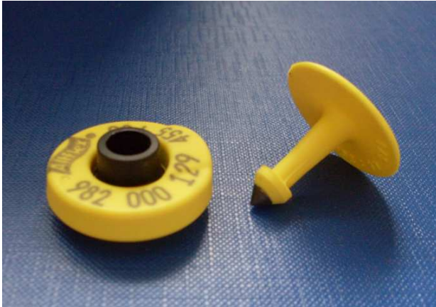
Figura 1. Tipo di transponder usato per il riconoscimento dei suini.
