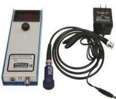
Figura 11. Rilevatore ad ultrasuoni dello spessore del lardo dorsale Renco Lean Meter
