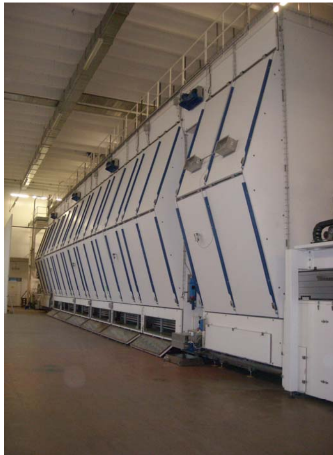
Figura 3.1: Impianto di essiccazione in funzione nell'Azienda Alimentare Ferraro.
