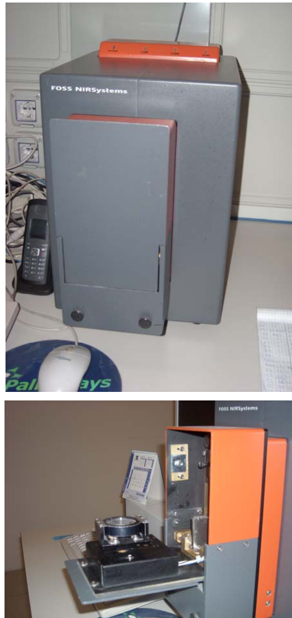
Figura 2.1: Spettroscopio NIR utilizzato per analizzare le sfoglie di pasta.
